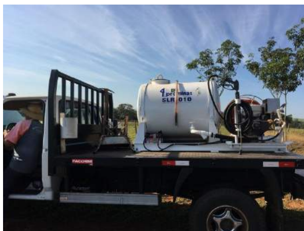
Foto 3.35 – Caminhão hidrojato utilizado na limpeza dos desarenadores
