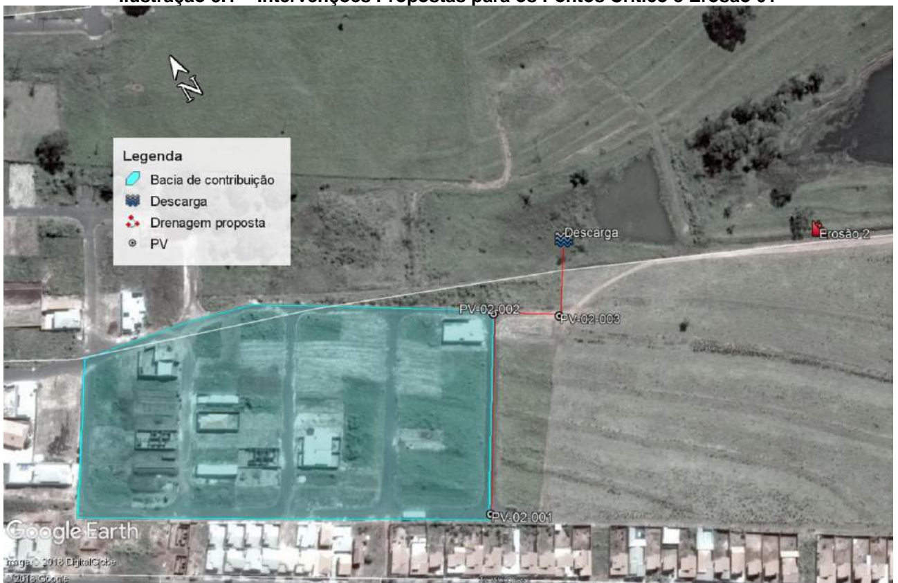
Ilustração 8.2 – Intervenção Proposta para o Ponto de Erosão 02
