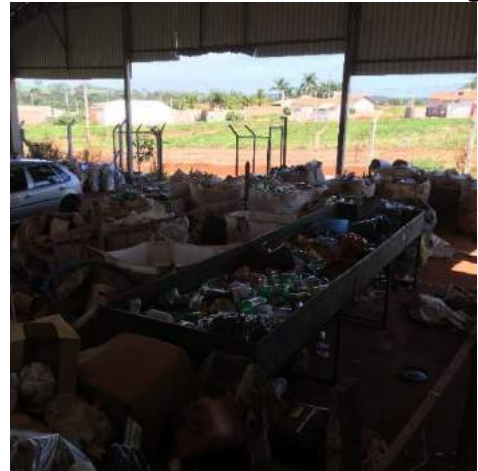
Foto 3.54 – Vista da esteira para separação manual dos resíduos
